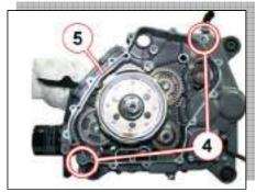
• Remove the generator rotor bolt.
