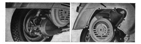
Fig. 21 - Serial number stamped on engine Fig. 21 - Numeración sobre el motor Fig. 22 - Serial number stamped on frame Fig. 22 - Numeración sobre el bastidor PIAGGIO & C. - S. p. A. - PONTEDERA S.I.A.T. - Ufficio Pubblicazioni Tecniche Dis. N. 99748 5.a EDIZIONE, 2000/6903
